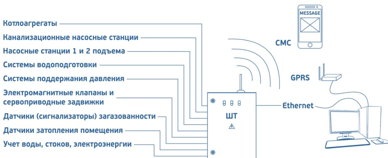
Рис.1.3.8.3 «Система телеметрии»
