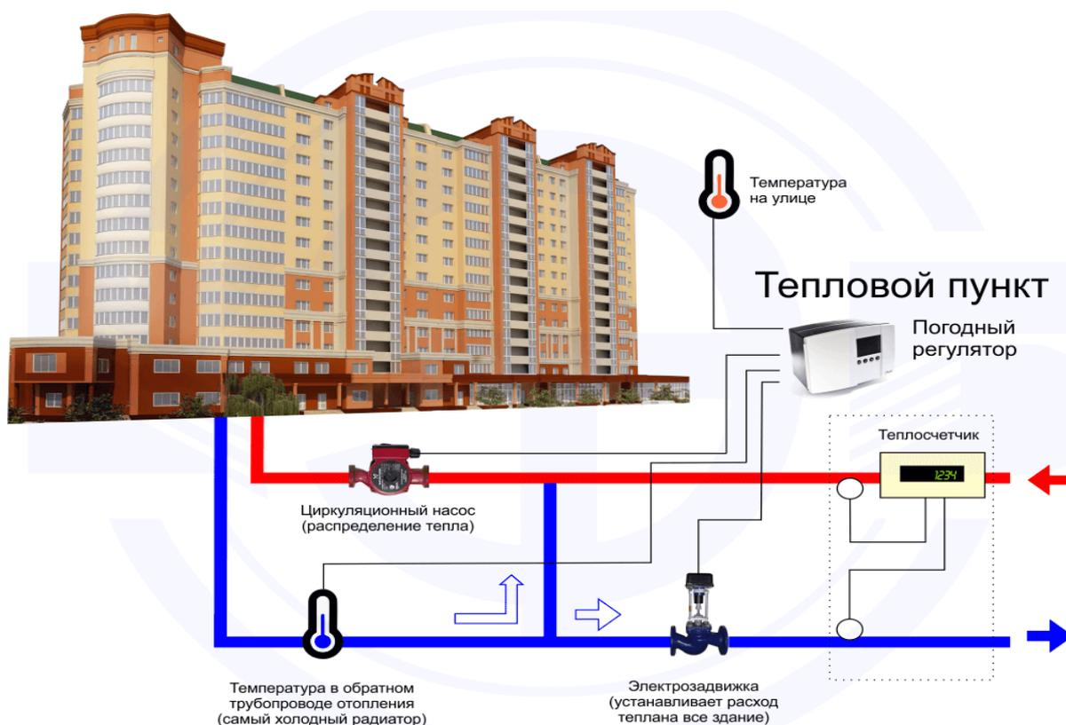
**Рис.1.3.8.1 «Схема регулирования погодозависимой автоматикой»**
